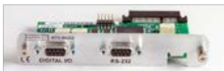
KTTI-RS232 – интерфейс RS-232 с 6 цифровыми портами ввода-вывода.
