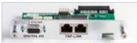
KTTI-TSP – интерфейс TSP-Link с 6 цифровыми портами ввода-вывода.
